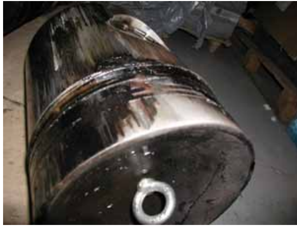
Fig 1.1 Piston de gran tamaño con marcas de gripado
