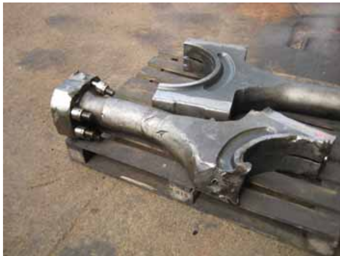
Fig 1.2 Estado en que quedó una biela tras un gripaje
